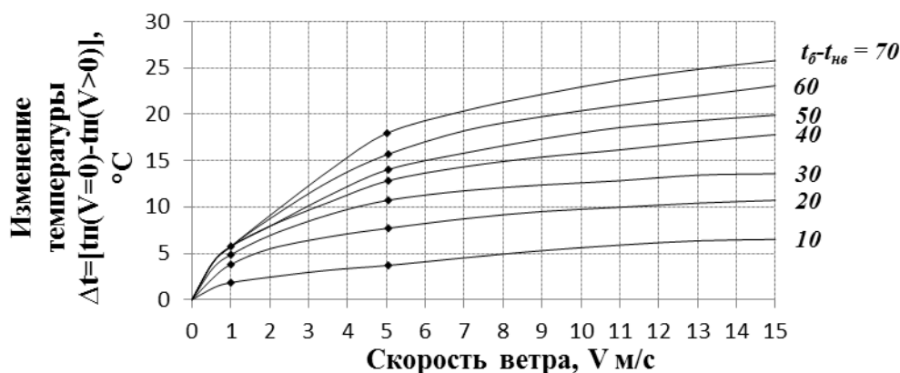
Рис. 2. Изменение температуры поверхности фанерной палубы ( R=0,175 \text{ м}^2 \cdot ^\circ\text{C}/\text{Вт} ) от действия ветра ( V=0 \dots 15 \text{ м/с} ): зависимость величины отклонения \Delta t от скорости ветра и величины температурной разности t_\delta - t_{нв} . Принятый коэффициент конвективной теплоотдачи подчиняется зависимости \alpha_k = 3,25 + (6 \cdot V)^{0,8} , \text{Вт}/\text{м}^2 \cdot ^\circ\text{C} ; \varepsilon = 0,95
