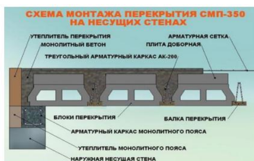
Рис. 8. Варианты сборно-монолитные перекрытия «ЮНИЛИТ»
