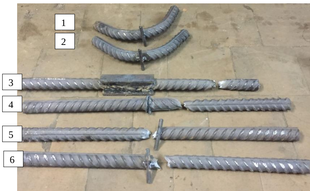
Рис. 4. Характер разрешения арматуры А500С Ø32 мм
