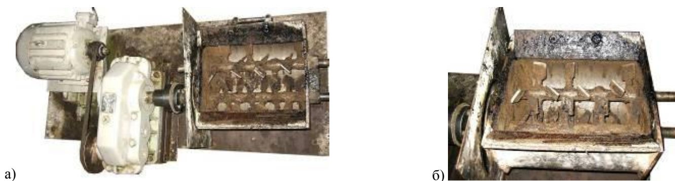
Рис.1. Мешалка лабораторная (с горизонтально расположенными валами с лопатками) а) Общий вид; б) Рабочая камера
