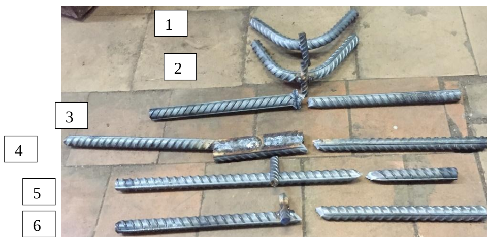
Рис. 3. Характер разрешения арматуры А500С Ø18 мм
