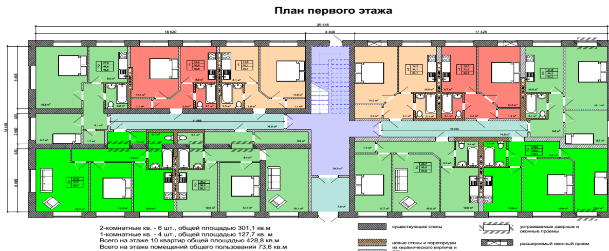
Рис. 6. План первого этажа после реконструкции
