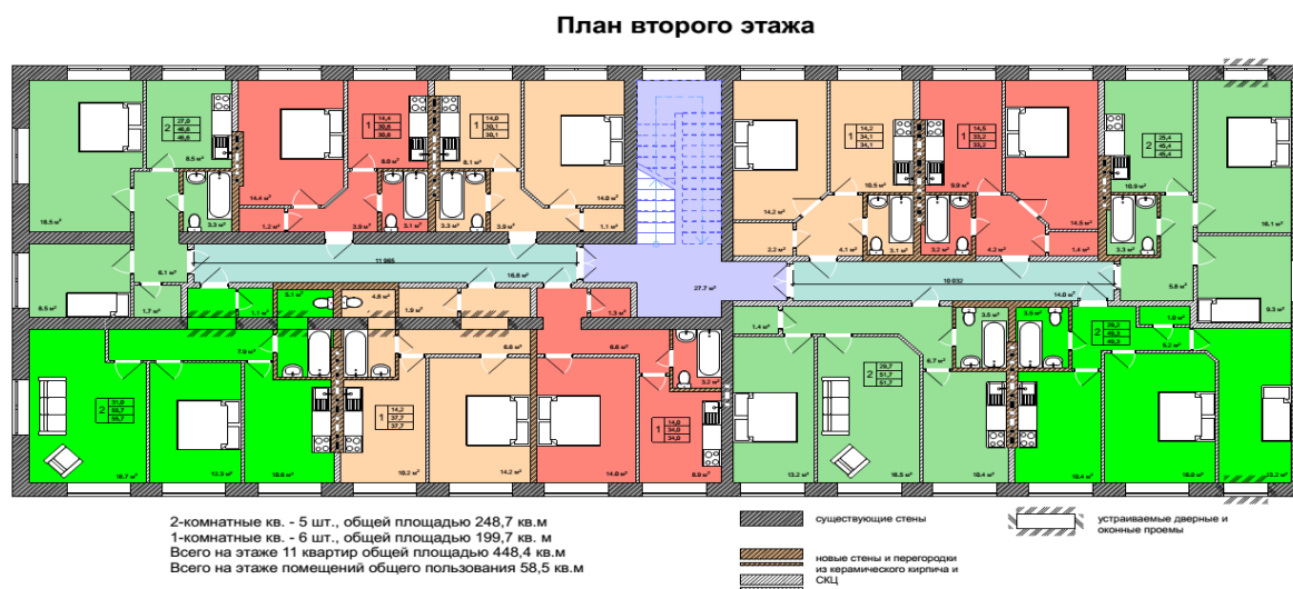
Рис. 7. План второго этажа после реконструкции
