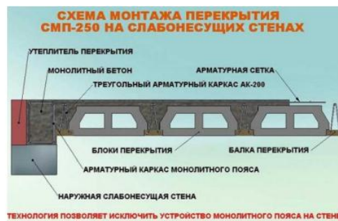
Рис. 8. Варианты сборно-монолитные перекрытия «ЮНИЛИТ»
